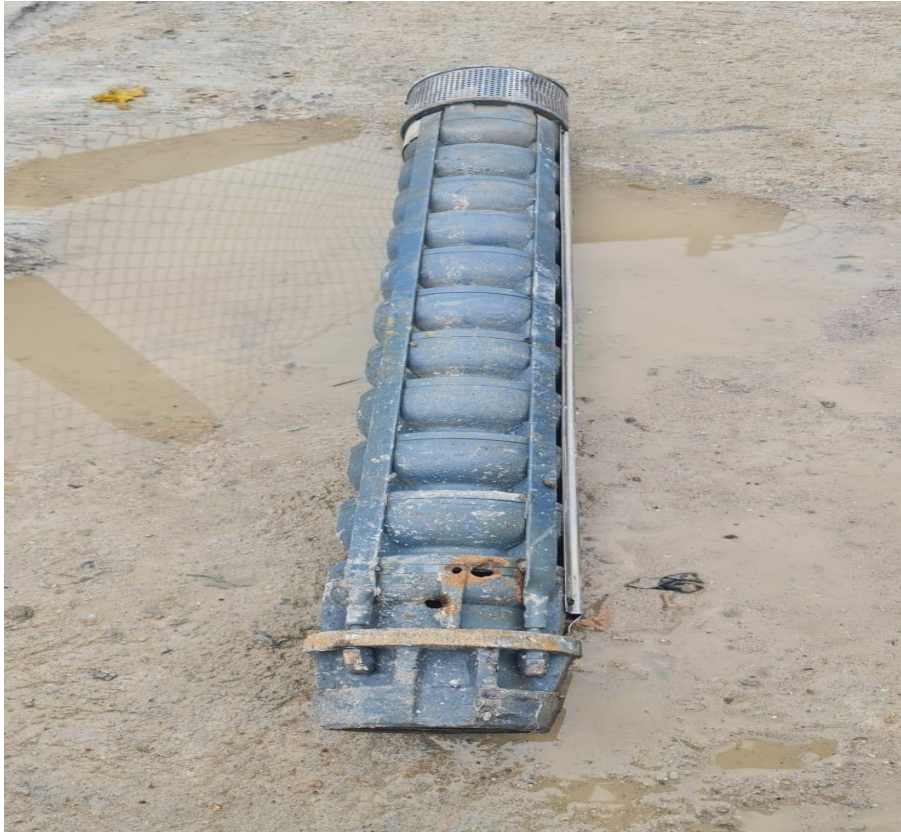
BOMBEADOR FURADO SUBSTITUÍDO
